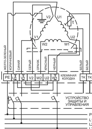
Трехфазный электродвигатель вентилятора VR 90-50/45.4D с частотным регулятором. Питание 380В
