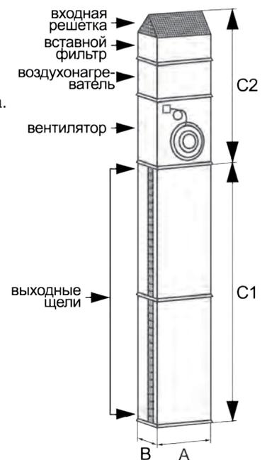
Воздушные завесы предназначены для использования на промышленных, общественных и хозяйственно-бытовых объектах для защиты помещения от проникновения наружного воздуха через дверные проёмы или ворота. Применение воздушной завесы помогает сократить теплопотери до 90%, что позволяет снизить затраты на обогрев. В теплое время года воздушная завеса удерживает внутри помещения охлажденный воздух, поступающий от кондиционера.
