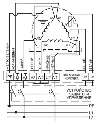
Трехфазный электродвигатель вентиляторов -4D; -6D и -8D
