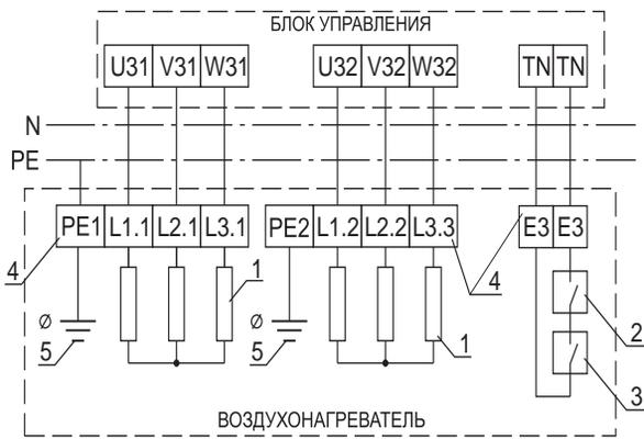
1 – ТЭНы, 2 – датчик температуры корпуса, 3 – датчик температуры воздуха, 4 - клеммы, 5 – болт заземления
