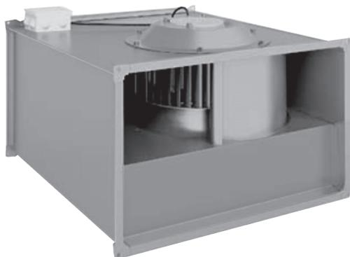
Радиальные вентиляторы VKR предназначены для перемещения воздуха и других воздушных невзрывоопасных газовых смесей, имеющих температуру от -30°C до +40°C не содержащих липких веществ, волокнистых и абразивных материалов, с содержанием пыли и других твердых примесей не более 100мг/м<sup>3</sup>.
