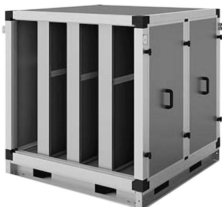
Шумоглушитель применяется для снижения уровня шума в канале от вентиляционного агрегата. Конструкция шумоглушителя представляет собой короб, собранный из кассет, с установленными внутри плитами из звукопоглощающего материала. Звукопоглощающим материалом служит обладающая высокими акустическими свойствами базальтоволокнистая минеральная вата. Для предотвращения выдувания частиц минеральной ваты кассеты обтянуты специальным материалом.
