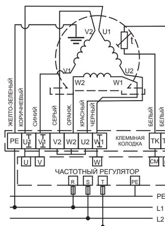
Трехфазный электродвигатель вентилятора VKS 90-50/45.4D
