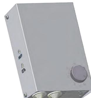
Электронный (симисторный) регулятор мощности PULSAIR-R предназначен для регулирования мощности однофазных и двухфазных электрических обогревателей, работающих от сети с напряжением 220/380В. Регулятор предназначен для крепления на вертикальной плоскости и включается последовательно между сетью питания и электрообогревателем.
