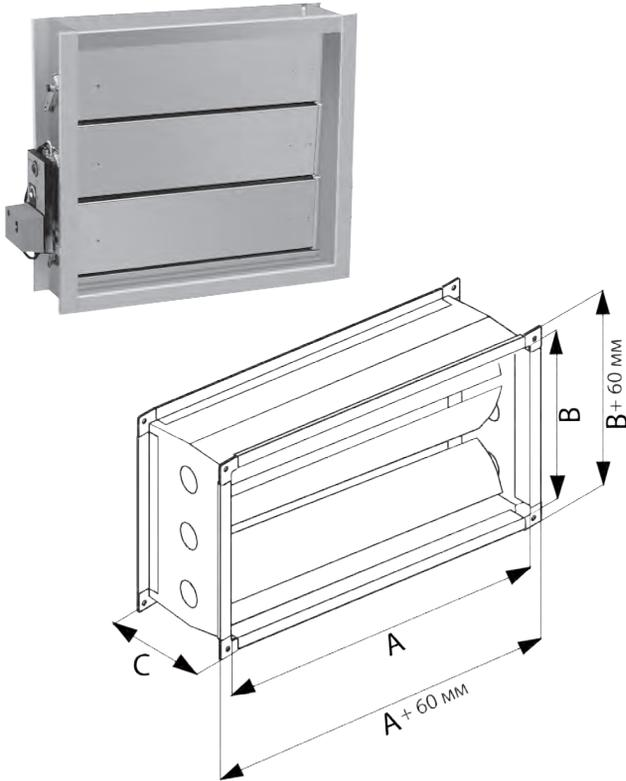
Клапаны предназначены для регулирования расхода воздуха в каналах прямоугольного сечения и перекрытия воздушного канала во время остановки работы системы вентиляции.
