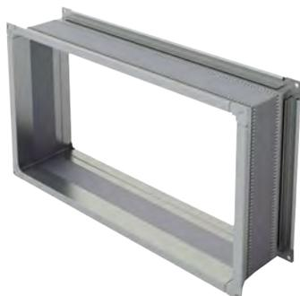
Гибкие вставки применяются для исключения передачи вибрации на сеть воздуховодов, компенсации несоответствия осей воздуховодов и установки. Фланцы гибкой вставки изготовлены из оцинкованной стали и соединены прочным и эластичным виниловым материалом, исключающим утечки при длительном сроке эксплуатации.
