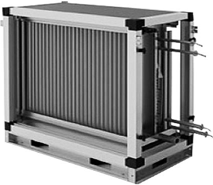
Фреоновый охладитель предназначен для охлаждения приточного воздуха. Теплообменник состоит из медных трубок, оребренных алюминиевыми пластинами. Все секции оснащены профильным пластиковым каплеуловителем и поддоном с патрубком для сбора и отвода конденсата. Теплообменник с поддоном и каплеуловителем расположен на специальных направляющих, что позволяет легко извлекать его из корпуса для обслуживания и ремонта.
