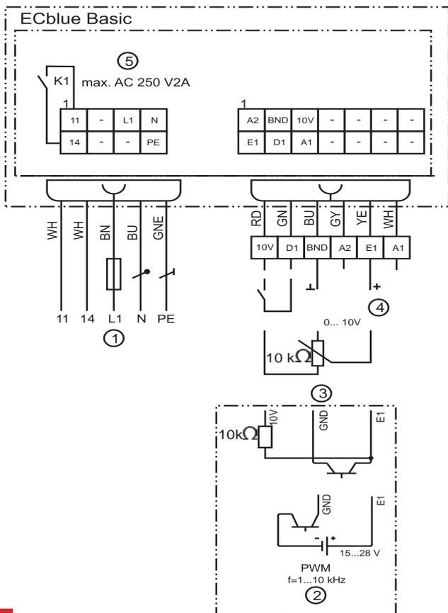
Вентиляторы с электронно-коммутируемым двигателем:
