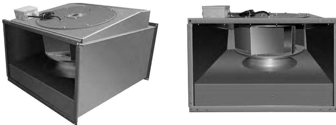
Вентиляторы радиальные канальные с загнутыми назад лопатками типа WRK предназначены для перемещения воздуха и других невзрывоопасных газовых смесей, агрессивность которых по отношению к углеродистым сталям обыкновенного качества не выше агрессивности воздуха, имеющих температуру от -30°C до +40°C, не содержащих липких веществ, волокнистых и абразивных материалов, с содержанием пыли и других твердых примесей не более 100мг/м<sup>3</sup>.
