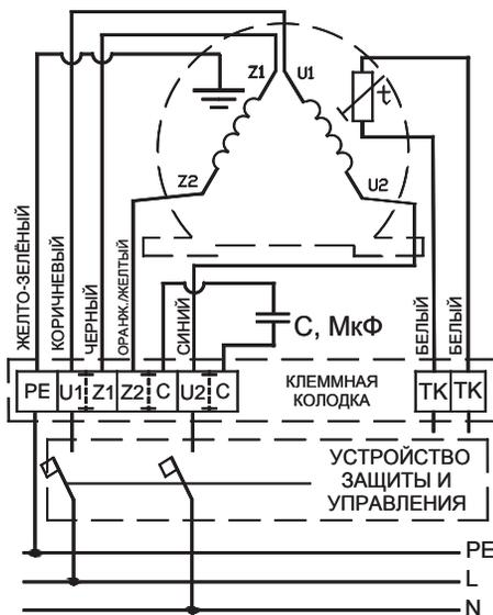
Однофазный электродвигатель вентилятора.
