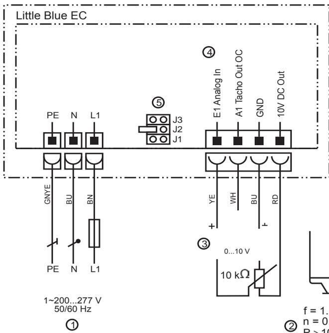
Вентиляторы с электронно-коммутируемым двигателем:
