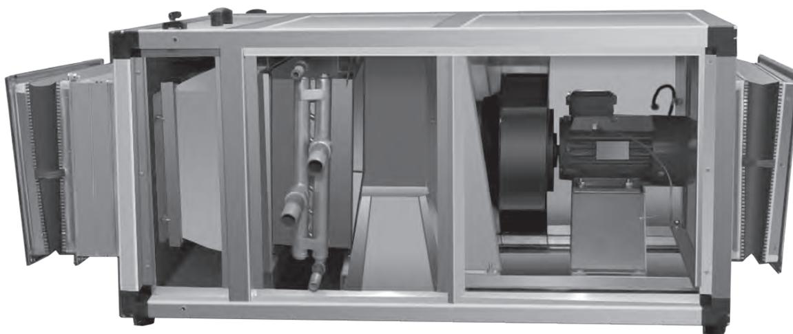
Приточная установка PUMA представляет собой жесткую каркасную конструкцию, выполненную из алюминиевого профиля с панелями толщиной 25мм. Установка может включать в себя различные секции такие как: воздушная заслонка, фильтр, водяной калорифер, электрический калорифер, водяной или фреоновый охладитель с каплеуловителем, секции смешения, роторный или пластинчатый рекуператор, вентилятор и гибкие вставки.
