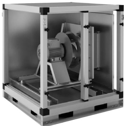
Секция вентилятора имеет свободное рабочее колесо, установленное непосредственно на валу электродвигателя. Вентиляторная группа располагается на жесткой стальной раме. Для предотвращения передачи вибраций от вентиляторной группы на корпус применяются высокоэффективные резиновые виброизоляторы.
