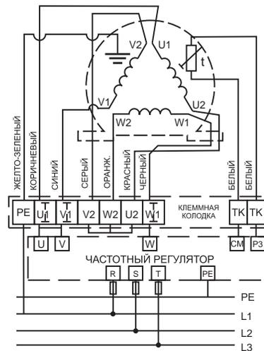
Трехфазный электродвигатель вентилятора VR 90-50/45.4D без частотного регулятора. Питание 380В
