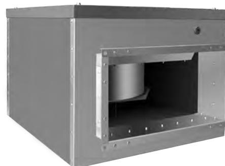
Вентиляторы VKS предназначены для перемещения воздуха и других невзрывоопасных газовых смесей, агрессивность которых по отношению к углеродистым сталям не выше агрессивности воздуха, имеющих температуру от  $-30^{\circ}\text{C}$  до  $+40^{\circ}\text{C}$  не содержащих липких веществ, волокнистых и абразивных материалов, с содержанием пыли и других твердых примесей не более  $100\text{мг/м}^3$ .
