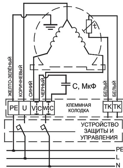
Трёхфазный электродвигатель вентиляторов -4D; -6D и -8D
