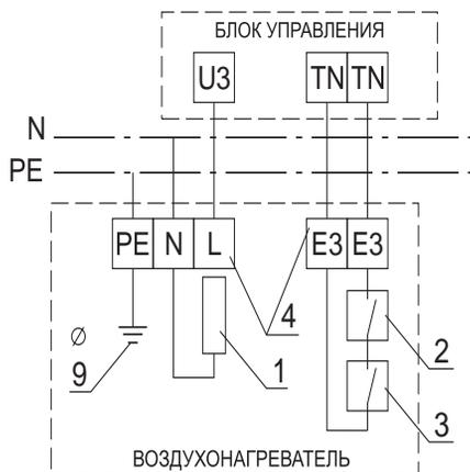
1 – ТЭНы, 2–датчик температуры корпуса, 3 – датчик температуры воздуха, 4 – клеммы, 5 – болт заземления.
