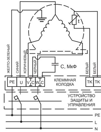
Трехфазный электродвигатель вентиляторов -4D; -6D; -8D с частотным регулятором мощностью до 4кВт. Питание 220В
