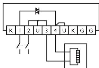
Внешний дополнительный термодатчик и устройство TG-R4... в качестве задатчика настроек
