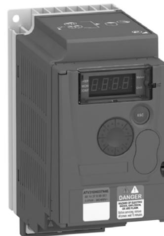
Благодаря инновационной схеме распределения потоков охлаждающего воздуха и усиленному покрытию плат, серия может использоваться в самых агрессивных условиях эксплуатации. Допускается работа при температуре воздуха вокруг преобразователя частоты до 55°C без корректировки его технических характеристик. При превышении температуры следует применять кривые снижения выходного тока, приведенные в Руководстве пользователя. Степень защиты IP 20 (IP41 в верхней части преобразователя частоты).
