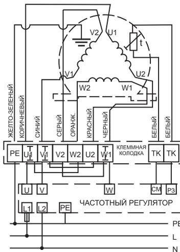
Трехфазный электродвигатель вентиляторов -4D; -6D; -8D с частотным регулятором мощностью от 4кВт (кроме VR 90-50/45.4D). Питание 380В
