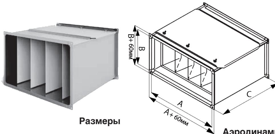
Корпус устанавливаются непосредственно в прямоугольные вентиляционные каналы и изготовлен из стального оцинкованного листа, для удобства обслуживания предусмотрена съемная крышка. Корпус предназначен для установки в нем карманного фильтрующего элемента соответствующего типоразмера. Класс очистки от EU3 до EU9.
