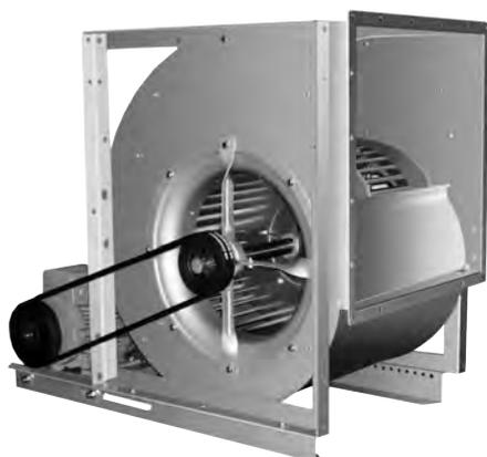
Секция вентилятора применяется для систем с высоким расходом и напором воздуха. Вентилятор имеет оригинальную раму, позволяющую установку резервного электродвигателя. При этом возможно использование резервного электродвигателя как при поломке основного двигателя, так и работы двигателей по таймеру для снижения наработки.
