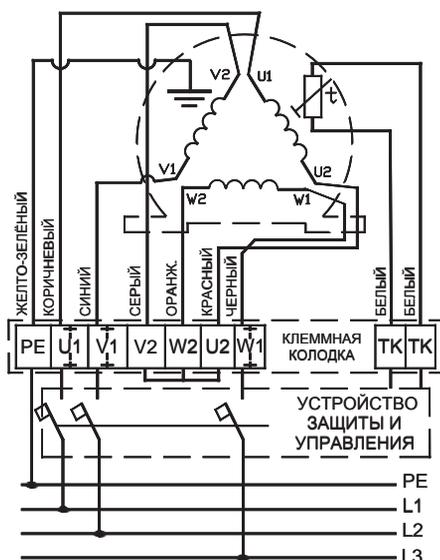
Трёхфазный электродвигатель вентиляторов -4D; -6D и -8D
