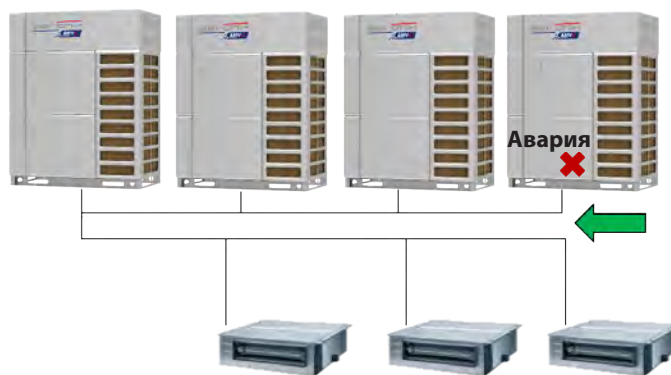
Извлечение хладагента из наружного блока
